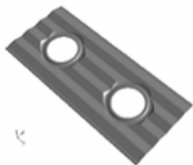
结霜状态下常用翅片：波纹片
